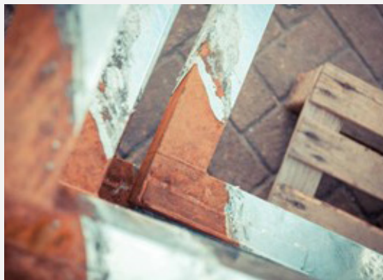
Foto 6 - door het niet aanbrengen van voldoende ontluchttingsgaten, is het voorwerp blijven hangen
