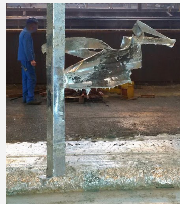
Foto 7 - geëxplodeerde tussenkoker in een frame door het ontbreken van verzinkgaten
