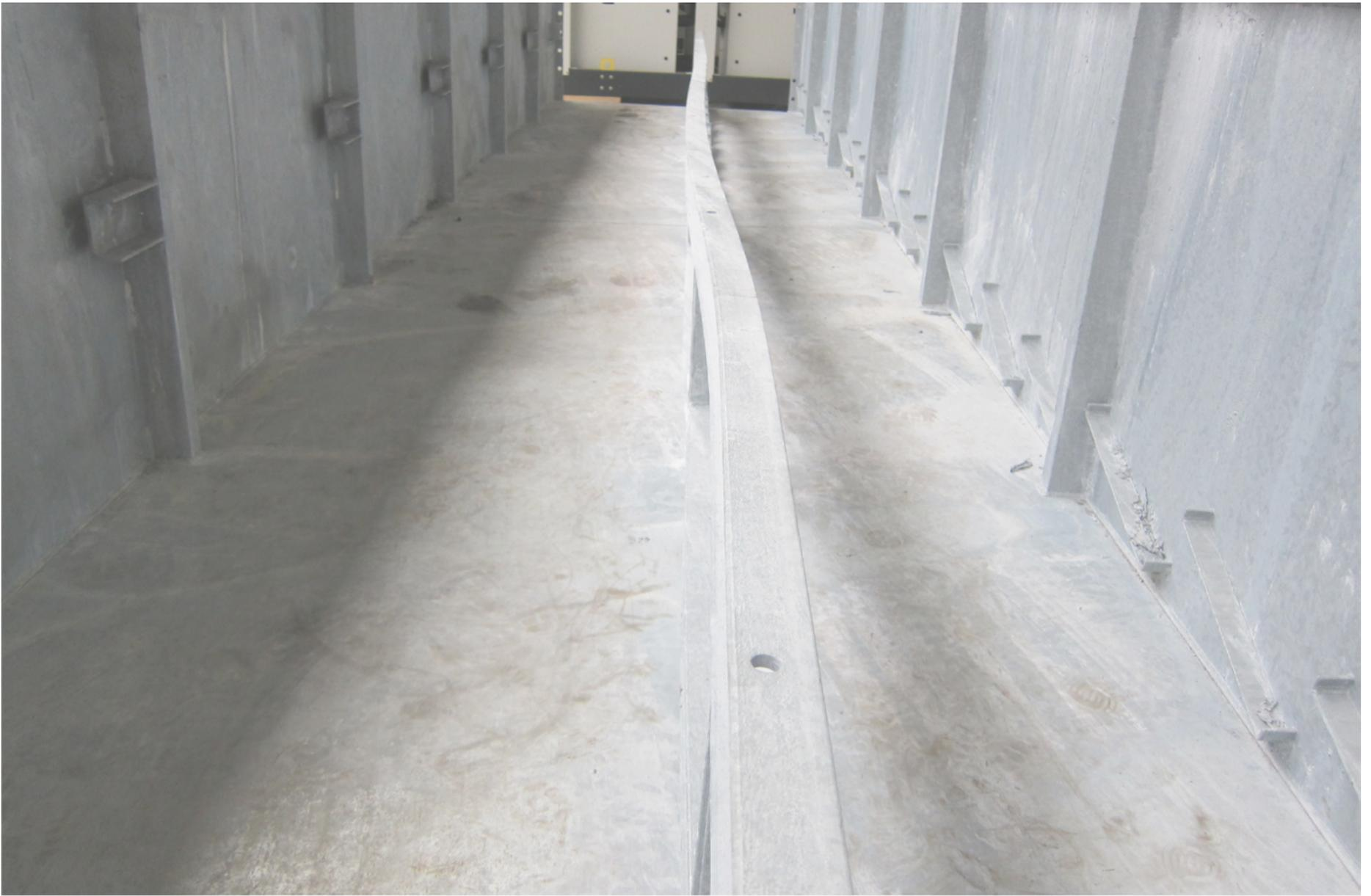
*Pendant le processus de galvanisation à chaud, les structures composites peuvent se déformer. Lorsqu'elles sont chauffées à 450° Celsius, les tensions présentes dans l'objet peuvent entraîner un jeu de forces qui provoque une déformation. Quelles sont les causes de la déformation et comment l'éviter ?*
