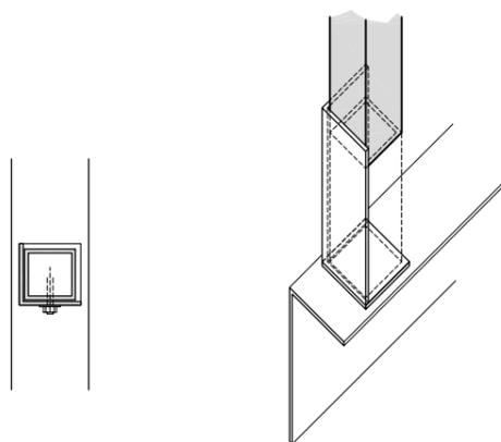
**Principe de pose balcon sur "capot béton"**
