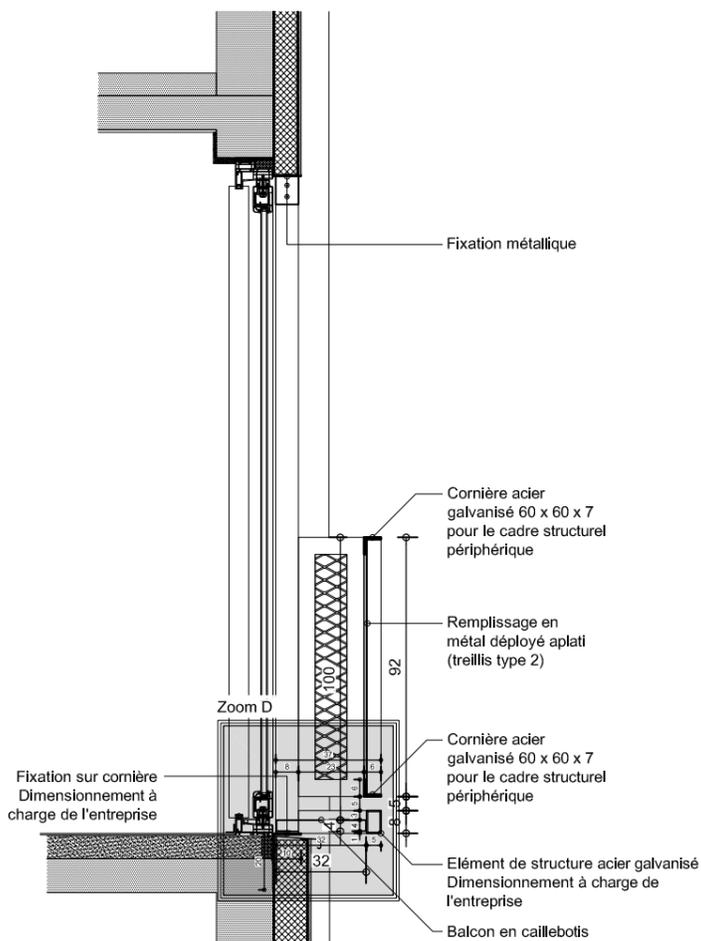
**Principe de pose balcon sur cornière**
