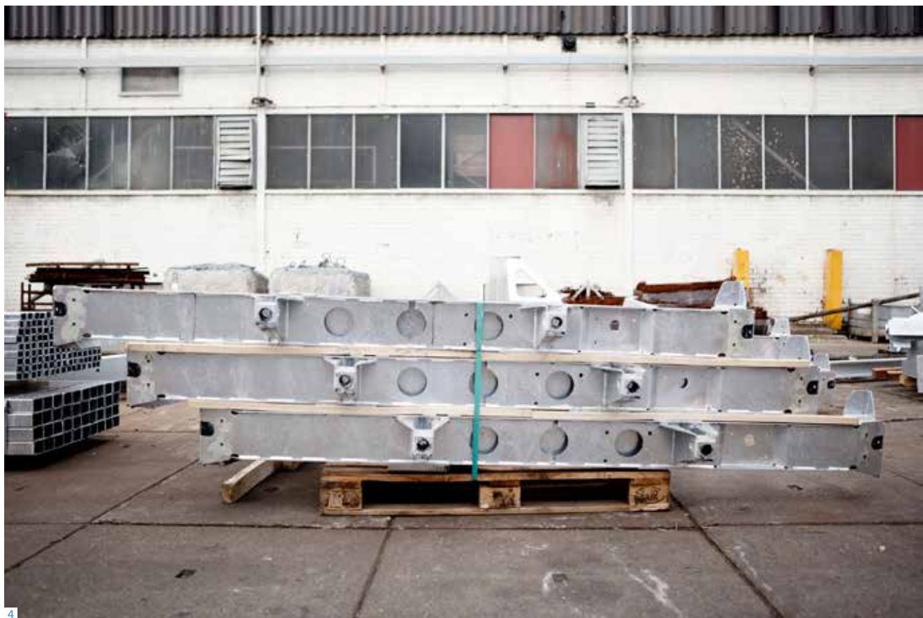
1, 2, 3, 4 Exemples de pièces galvanisées empilées correctement.
