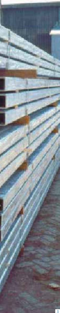
1, 2, 3, 4 Exemples de pièces galvanisées empilées correctement.
