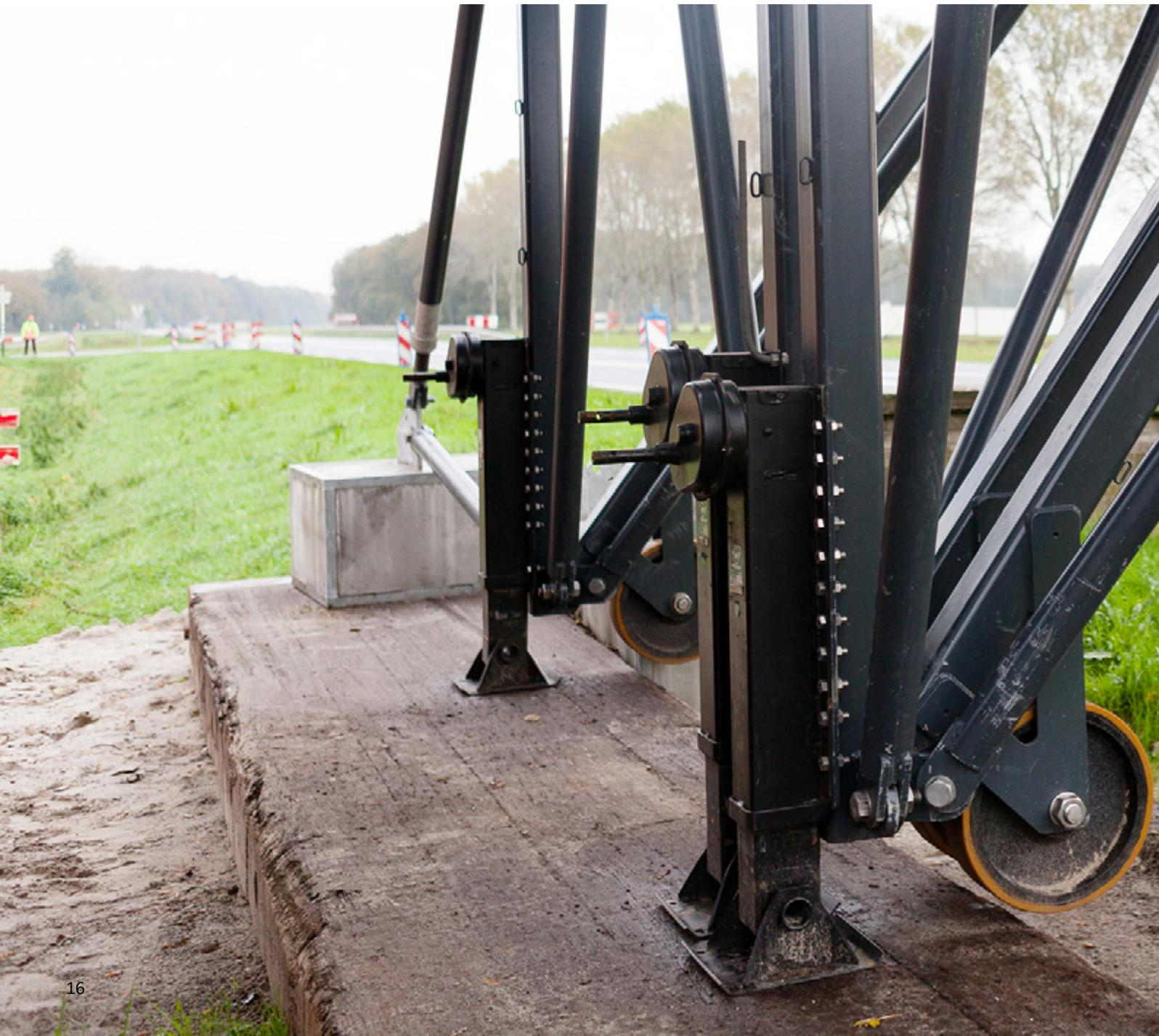
Le principe du pont est particulièrement flexible. Les pieds peuvent être placés transversalement ou dans le sens de la longueur et constituent les principaux points d'appui verticaux. L'une des exigences de Frank dès le départ, était que chaque pied devait être réglable séparément à 500 mm de hauteur en cas de terrain inégal. Les pieds
