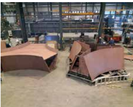
Locatie Almelo - samenstellen in mal.
