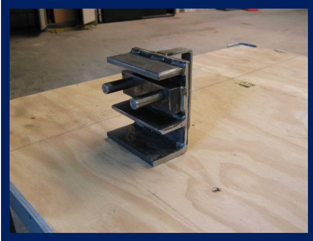
foto 6: controle steekmaat bevestigingspunten
