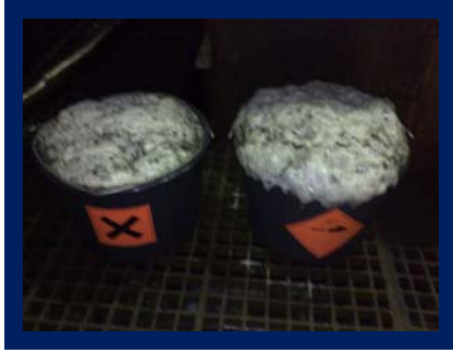
foto 7: proef waterstof en schuimvorming
