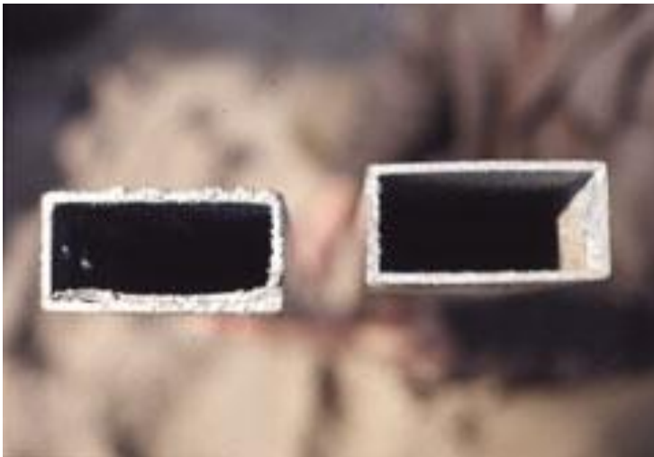
Links een braam, rechts afgebraamd
